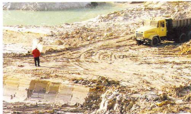
▲ Bild 9 • Tonabbau bei Dobropollje, Mächtigkeit am Tonstoß etwa 2 m
