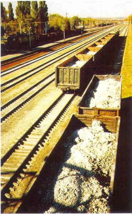
▲ Bild 12 • 60-t-Waggons der ukrainischen Bahn, mit Ton beladen und fertig für den Weitertransport
