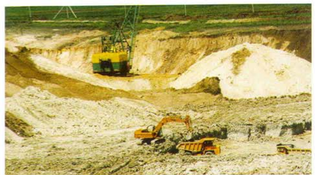
► Bild 10 • Tonabbau bei Drushkovka. Tonförderung mit Hydraulikbagger. Die graue Tonschicht ist an dieser Stelle 1,5 m mächtig. Der Abstand zum Seilzugbagger im Bildhintergrund beträgt ca. 150 m
